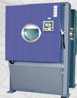
4. 为了降低制冷真空机组运行时产生的噪音，在机箱内壁安装有用于吸音、隔音的特种海绵吸音材料，主要的运动部件均采取了防振降噪措施。
