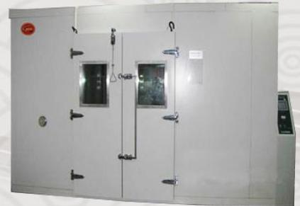
自主开发的多路、多级节流系统(制冷系统):本设备的制冷系统根据系统不同工况设计不同的毛细主路、旁路、通过智通控制系统根据工况自动控制,自动调节的毛细管节流系统,保证流量大小可调,达到了温度变化的目的,而且温度场变化均匀,温度波动极小。
