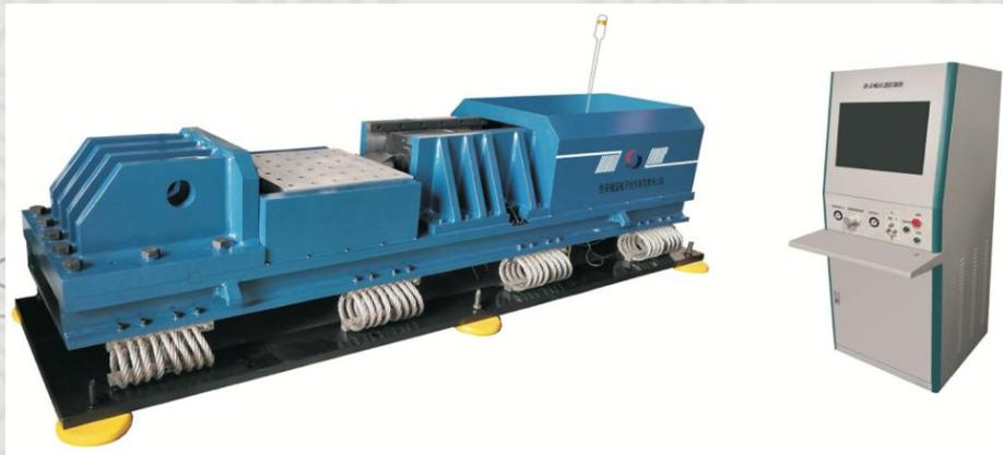
水平式冲击响应谱试验机
